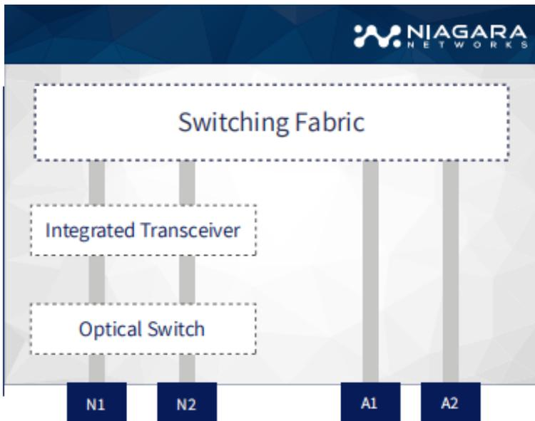
图 2: 设备端口可以同时作为功能齐全的 I/O 数据包旁路转发端口。
