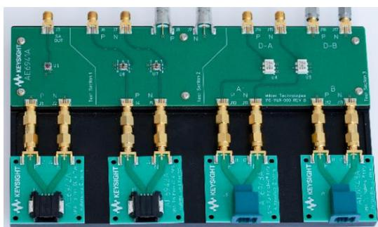
图 10. AE6941A 车载以太网测试夹具用于多项测试。
